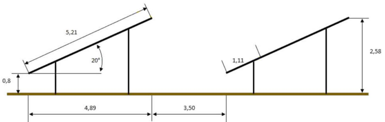
Bild 3.4.1: Skizze der Modulkonstruktion (Quelle: Auftraggeber, Ausschnitt)
