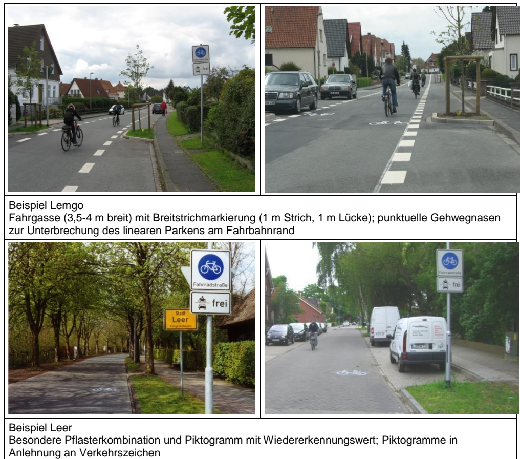
Abb. 6-6: Beispiele zur Ausgestaltung einer Fahrradstraße
